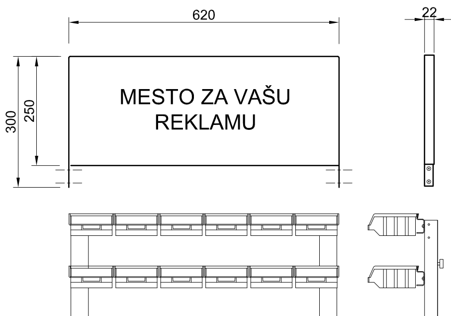
reklamni pano i stojeći nosač pre montaže
